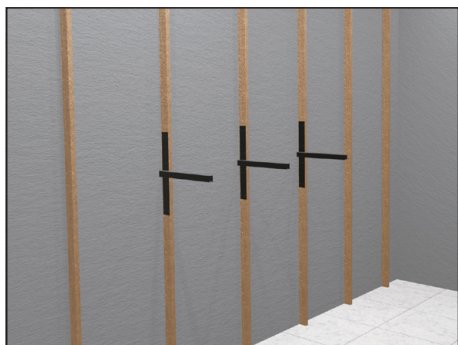
①角パイプで各棚受の水平を確認して芯材に固定します。
